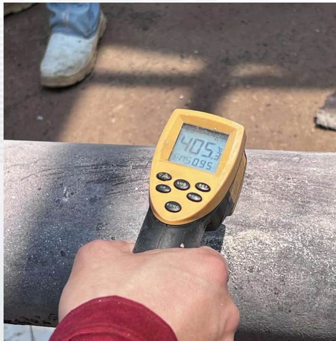
拆除传统保温材料管道效果： 405℃
